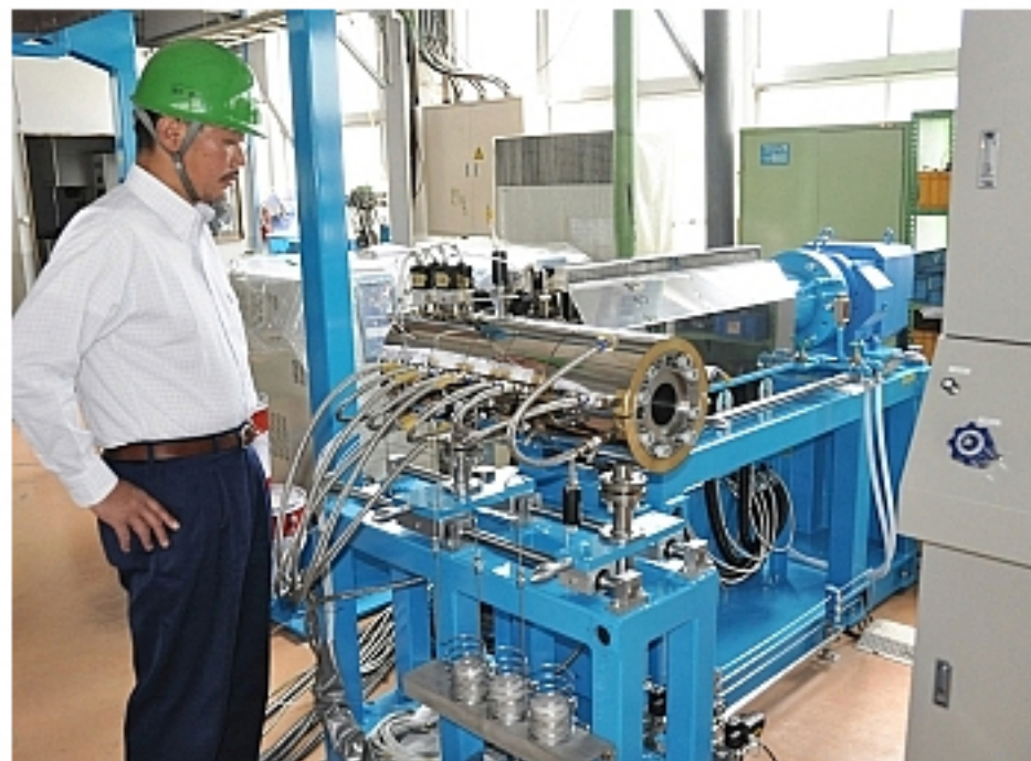
三葉製作所が試作した電線被覆装置。樹脂を発泡させる工程を工夫した
